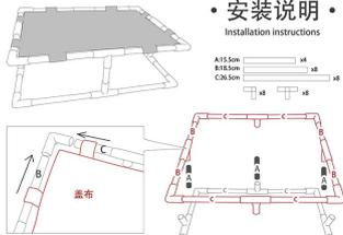
\*安装上指框架的时候将吊床的8个织带穿入支架
