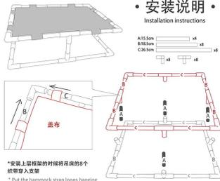
\*安装上指框架的时候将吊床的8个织带穿入支架
